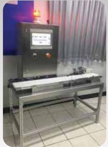
เครื่องชั่งน้ำหนักสินค้าและ นับจำนวนอัตโนมัติ
